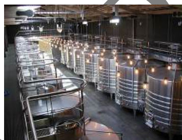
Airtight, fermentation tanks
